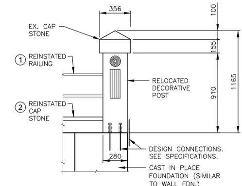
**ELEVATION END POST DETAILS - REHABILITATED**
